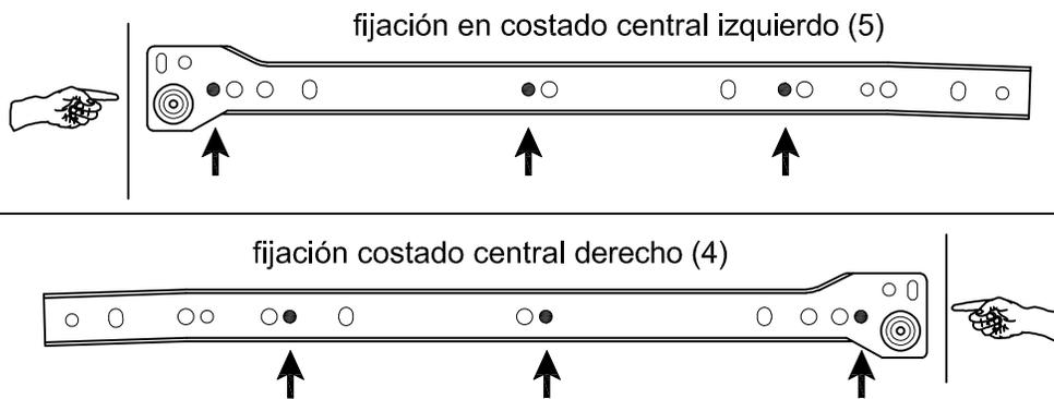
**PRECAUCION:** Las correderas metálicas no son iguales, son izquierda y derecha dependiendo del costado. Guíese de estos dibujos para su instalación (las ruedas siempre van hacia abajo).
