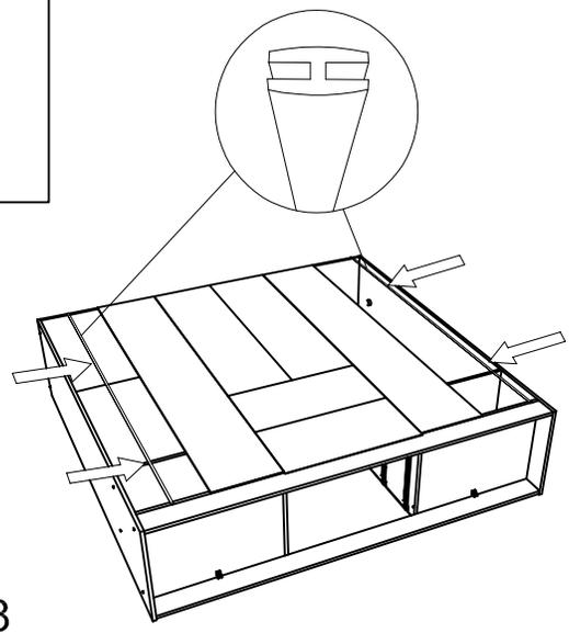
**8** Inserte las otras 2 traseras largas al perfil, luego clávelas a cubierta, costado y fondo, como muestra las imágenes.
