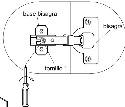
**10** Regule las puertas, aflojando y apretando el tornillo 1 en combinación con el tornillo 2, como se muestra en las figuras. Después de aflojar tornillo 1, ajuste posición de la puerta con el tornillo 2.
