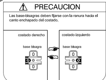
En los costados central derecho (4) y central izquierdo (5), fije las base-bisagras en las perforaciones guía (ver detalle) e instale el soporte barra en la perforación guía. Al igual que en los costados izquierdo y derecho, las perforaciones para los tornillos inferiores debe hacerlas usted.
